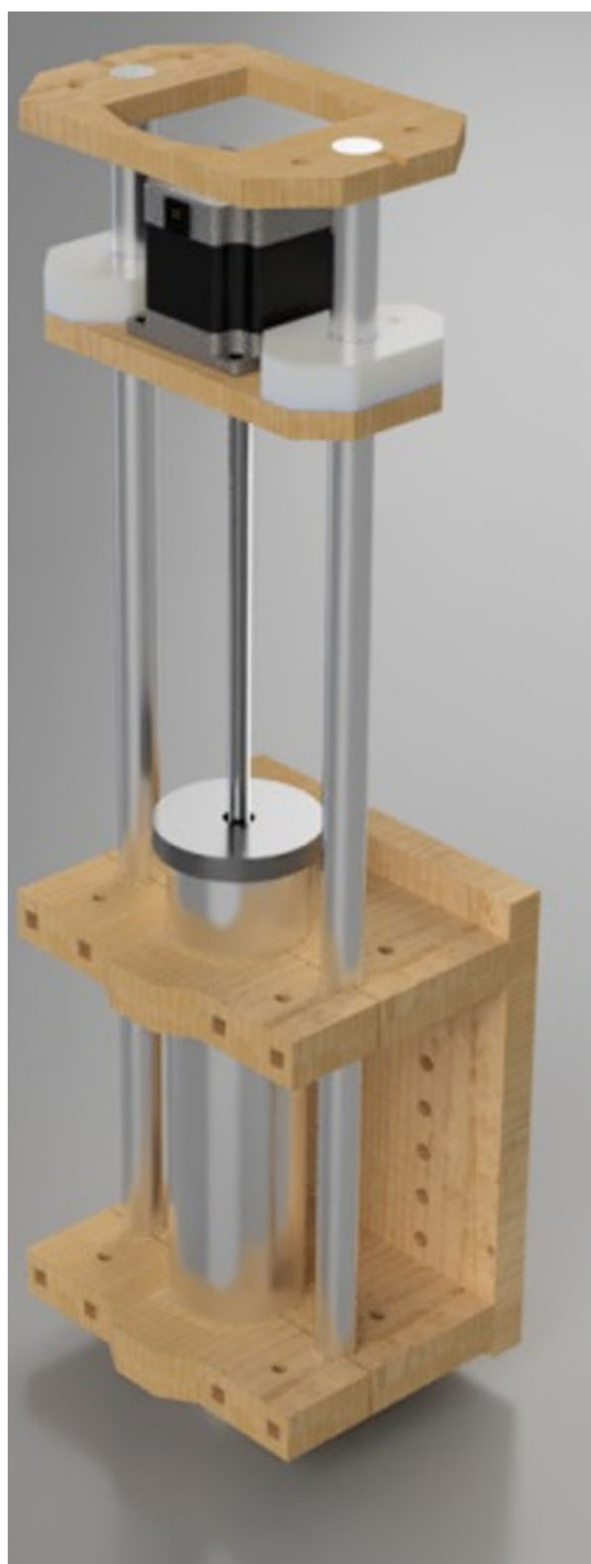
Рисунок 3 – Компоновка МФУ «РоботСМИД» под 3D-фрезерование (без управляющего компьютера)
