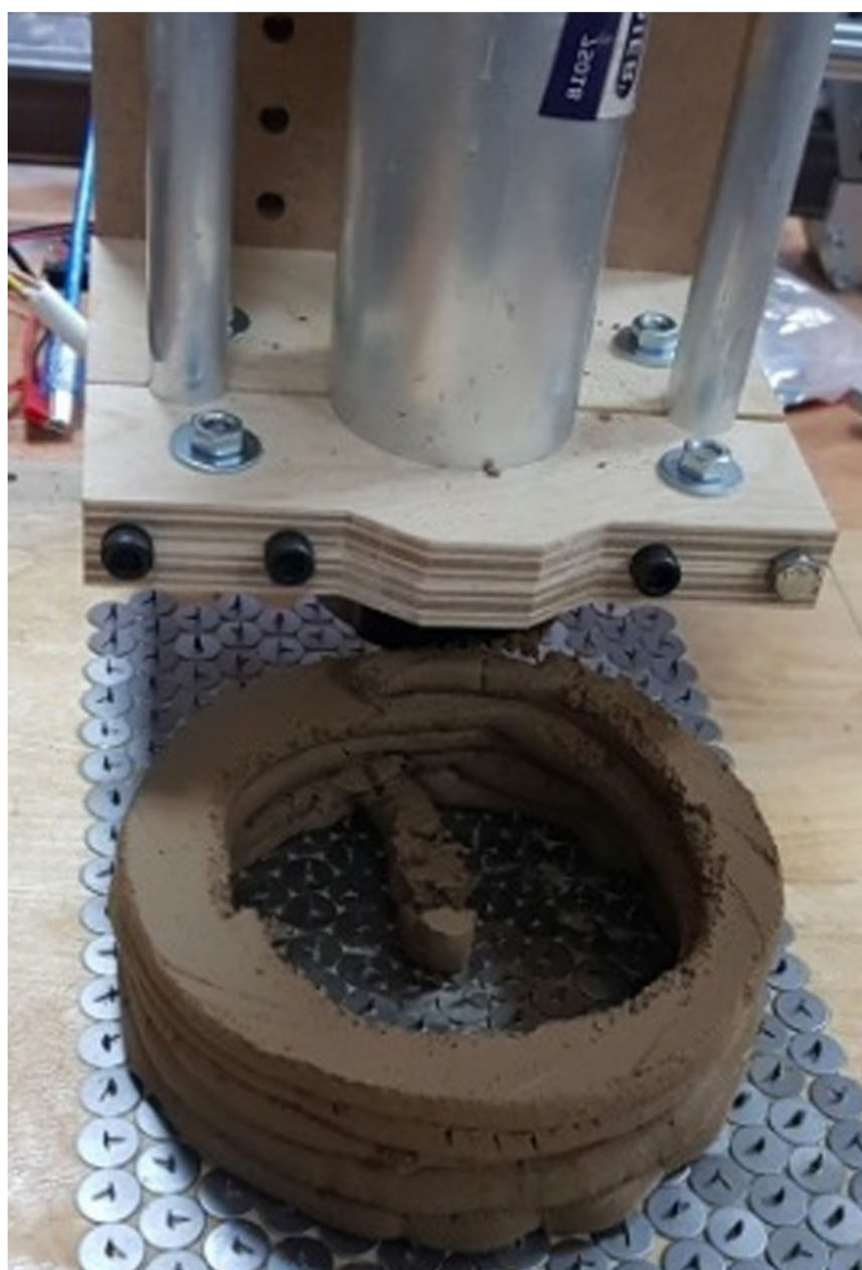
Рисунок 4 – Цифровые модели поршневого экструдера и объекта печати, выполненные в AutodeskFusion 360, и их материализованные копии
