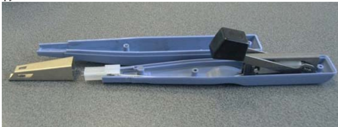
Рисунок 3. Пьезозажигалка в раскрытом виде с пьезогенератором
