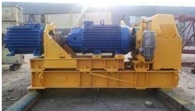
Рис. 11. Грузовая лебедка – одна из лебедок башенного крана
