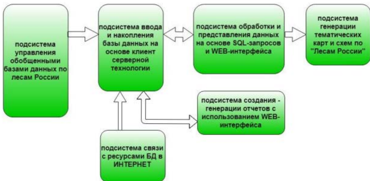
Рисунок 1 – Концептуальная структура функциональных подсистем геоинформационной системы
