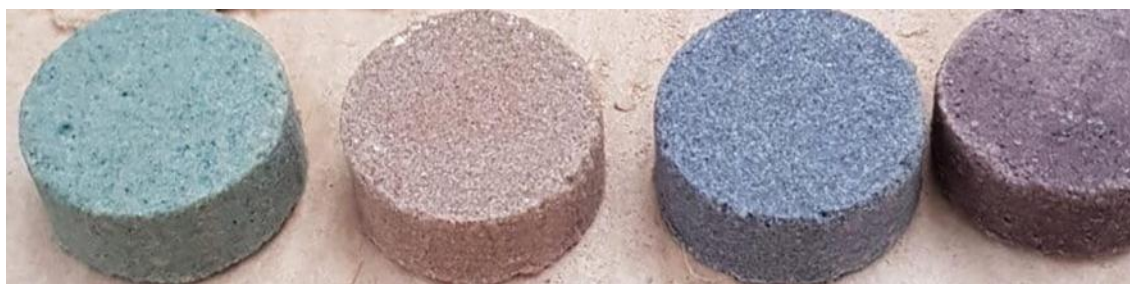
Рисунок 2 – Образцы с добавлением красителей (слева направо): оксид железа (III); оксид кобальта; краситель фиолетовый; оксид меди
