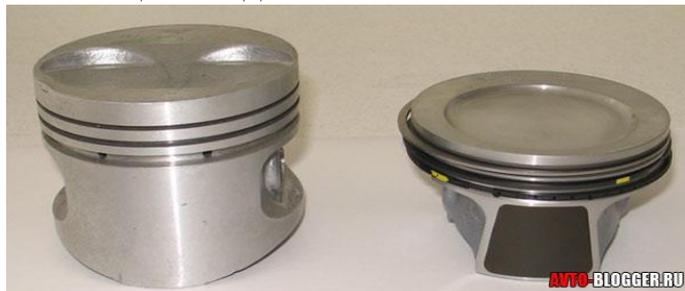
Рисунок 1 – Поршни с уменьшенной площадью юбки, одним компрессионным кольцом и одним маслоъемным.
