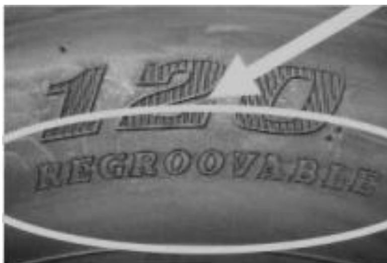
Рисунок 1- Указание возможности нарезки протектора, нанесенное на маркировке шины
