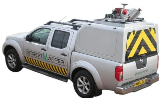
Рисунок 3 - Мобильный лазерный сканер StreetMapper 360 (со сканером RIEGL VQ-250) [6].
