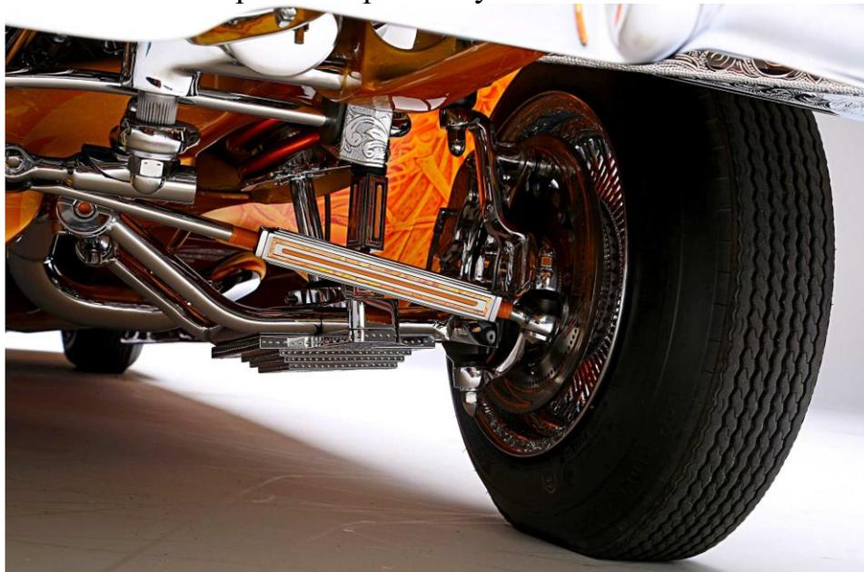
Рисунок 2 – Рессорная лоурайдерская подвеска автомобиля Шевроле Импала 1958 года
