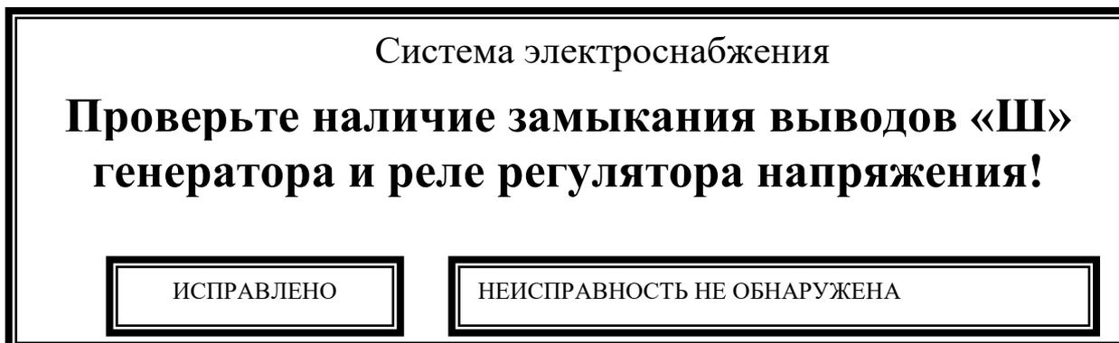
Рисунок 23 – Сообщение о подтверждении замыкания между выводами «Ш» генератора и реле регулятора напряжения
