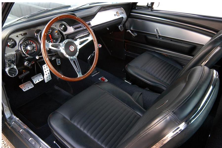
Рисунок 1 – Салон автомобиля Ford Shelby GT 500 1967 с использованием металлических накладок на большинство элементов, деревянным рулем и кожаными сидениями.
