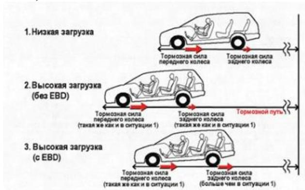
Рисунок 2 - Работа системы электронного распределения тормозных усилий
