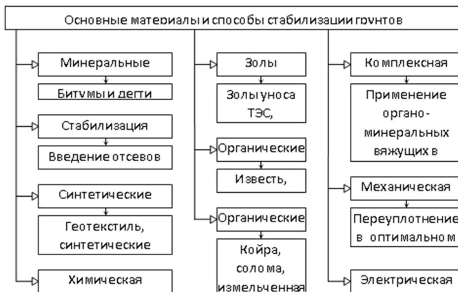
Рисунок 1 - Классификация основных стабилизаторов грунтов для дорог, применяемых при строительстве автомобильных дорог низших категорий в АПК
