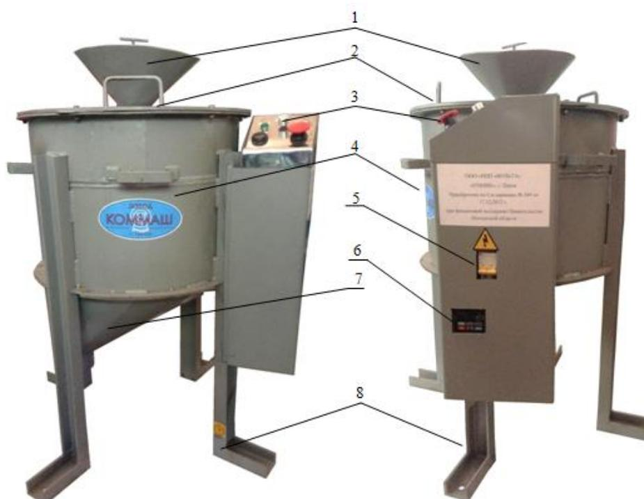
Рисунок 1 – Экспериментальный образец дискового устройства для шлифования: 1 – загрузочная воронка; 2 – верхний диск; 3 – панель управления; 4 – корпус привода; 5 – автоматический выключатель; 6 – частотный инвертор; 7 – бункер; 8 – опоры
