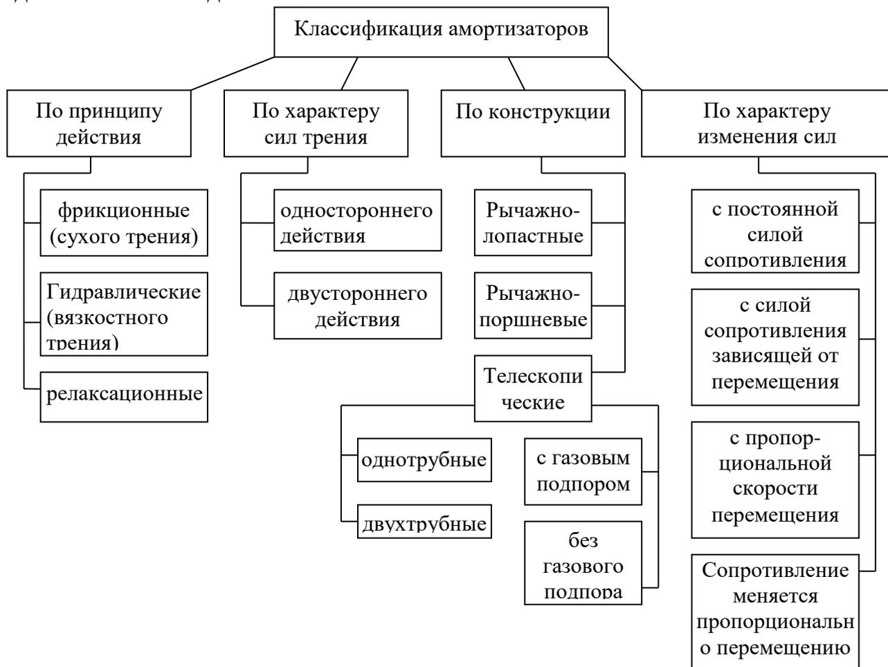
Рисунок 2 - Классификация амортизаторов
