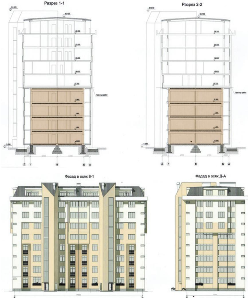
Рис. 3. Проект реконструкции с надстройкой 5 этажей
