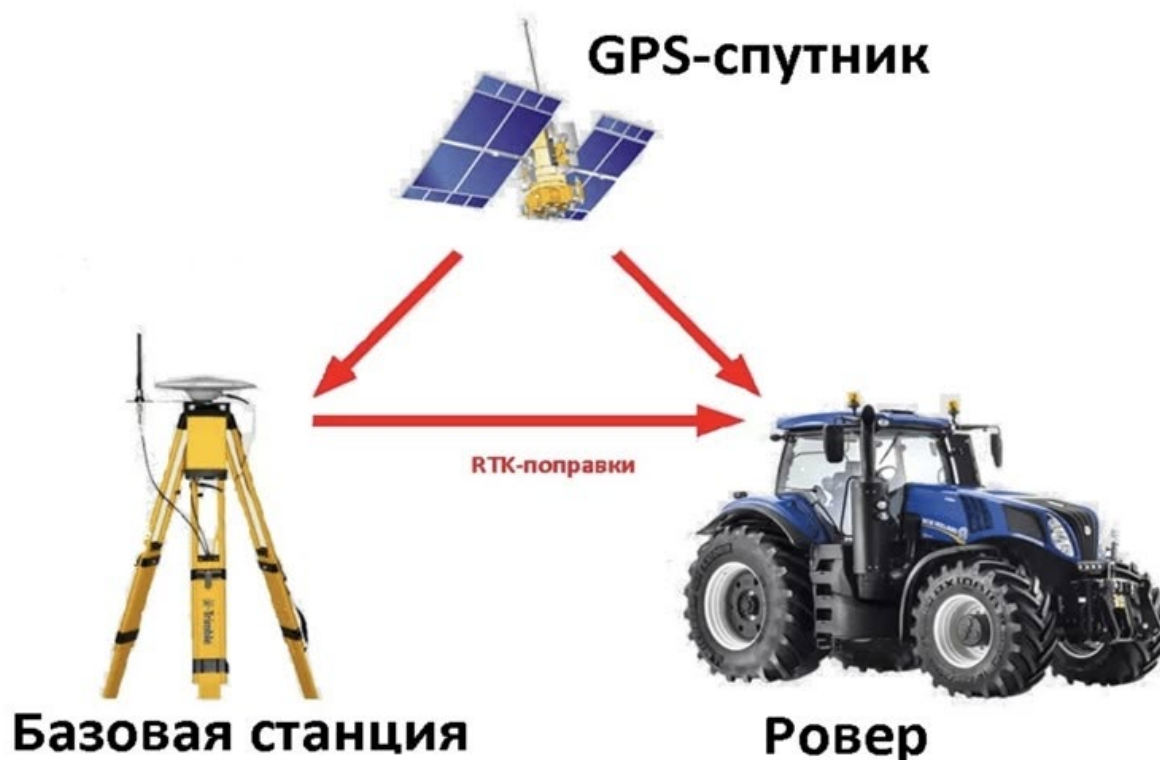
Рисунок 1 - Принцип взаимодействия GPS-спутника, базовой станции и ровера [1]
