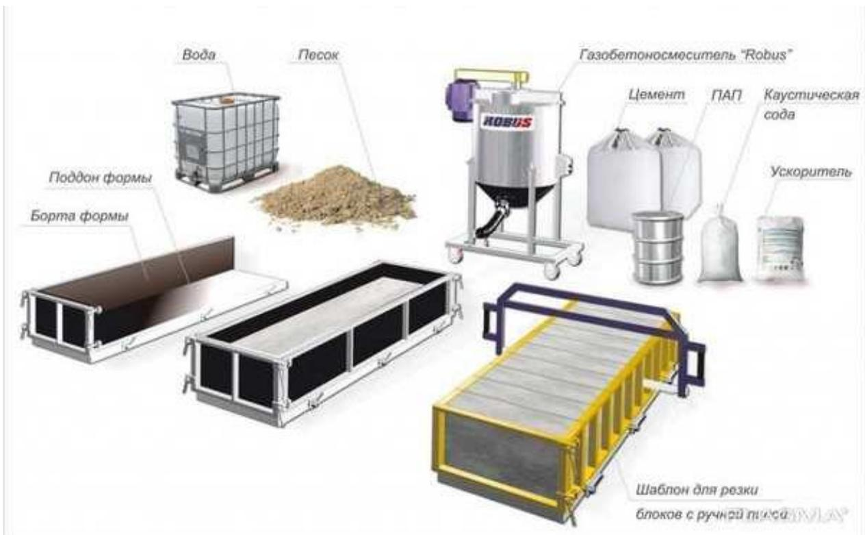
Рисунок 2 – Схема организации производства газобетонных блоков
