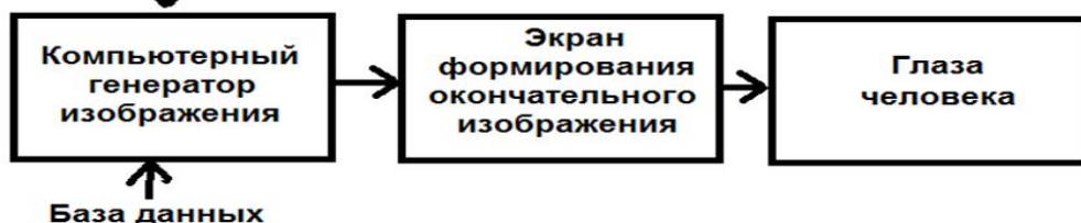
Рисунок 2 – Схема обработки информации в имитаторе тепловизора, синтезирующего 2D проекции в 3D изображений реперных объектов на местности
