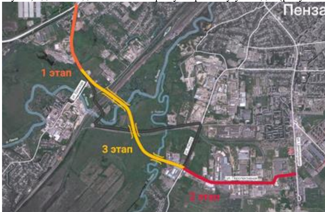
Рисунок 1. План реализации проектирования автомобильной дороги
