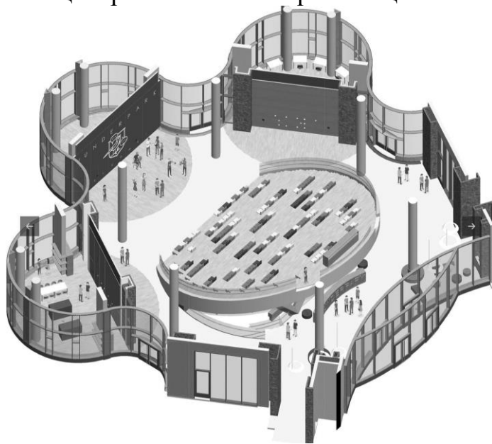
Рисунок 3 – Организация атриумного пространства с использованием трансформируемых перегородок, школа Wunderpark, Подмоскowie
