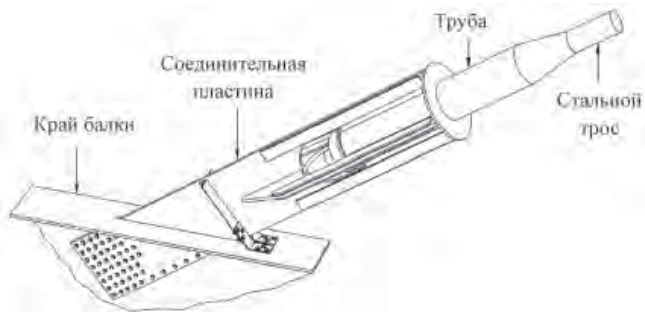
Рис. 5. Схема крепления троса к балке жесткости
