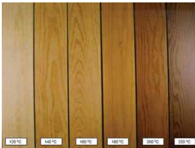
Рис. 3. Изменение цвета сосны в зависимости от увеличения температуры нагревания при термической обработке
