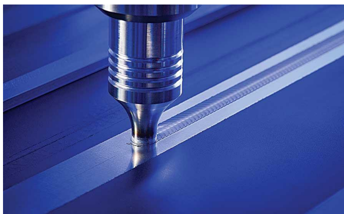
Рисунок 1 – Сварной шов, выполненный сваркой трением с перемешиванием
