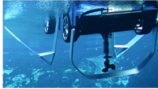
Рисунок 6 – На подводных крыльях Автомобиль-амфибия Rinspeed Splash
