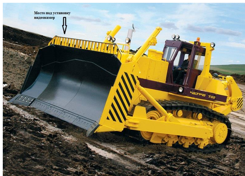
Рисунок 2 – Установка видеокamer вблизи с отвалом
