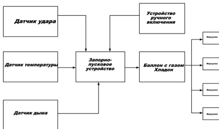
Рисунок 4 - Структурная схема автоматической газовой системы предупреждения возгорания автомобиля.
