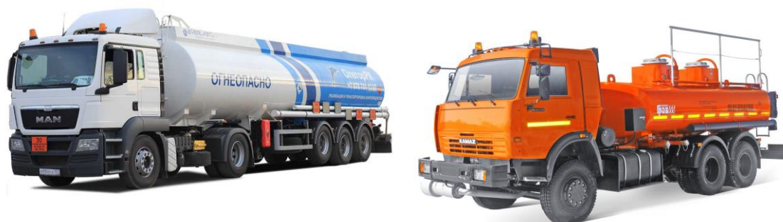
Рисунок 1 – Подвижной состав для перевозки светлых нефтепродуктов не оборудованный датчиками контроля [1]
