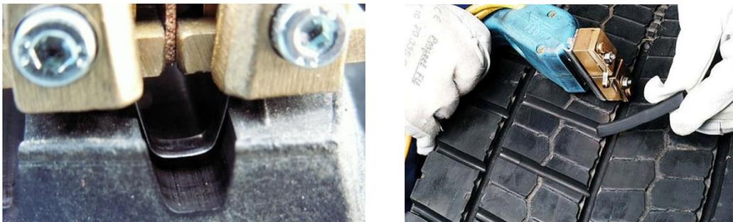
**Рисунок 3** - Процесс нарезки протектора регрувером
