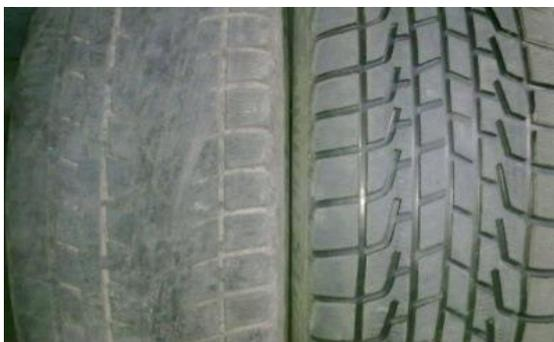
**Рисунок 4** - Общий вид изношенной шины грузового автомобиля (слева) и восстановленной путем нарезки протектора (справа)
