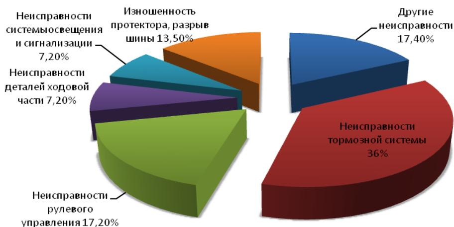
Рисунок 1 – Распределение ДТП по причинам технической неисправности автотранспортного средства
