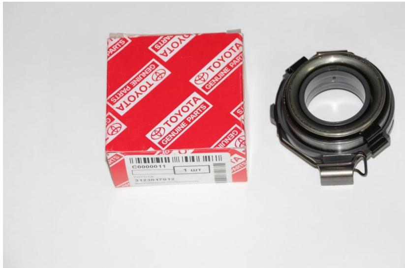
Рис. 1. Выжимной подшипник РКПП Тойота Королла.
