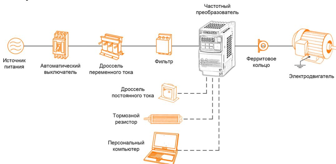
**Рисунок 2** – Функциональная схема частотно-регулируемого привода
