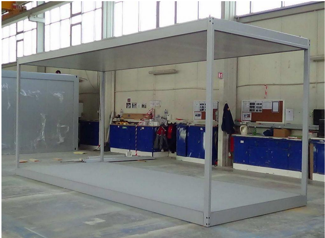
Рисунок 1 – Конструкция модуля Budget Line
