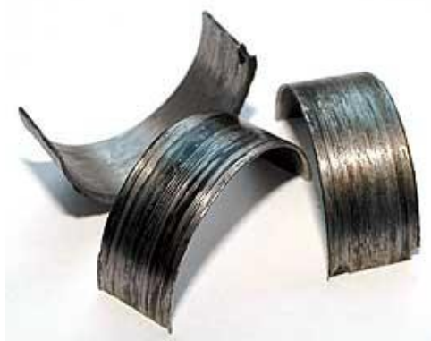
Рисунок 1. Последствия масляного голодания в двигателе КАМАЗ (вал ГРМ, шатунные вкладыши)
