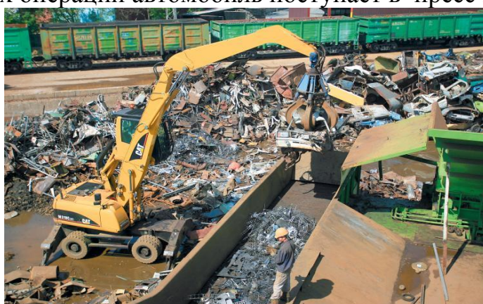
Рисунок 2. Погрузка корпуса автомобиля в шредер
