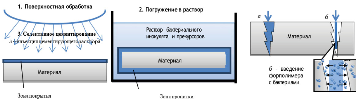
Рисунок 2. Методы локальной обработки бетонных изделий
