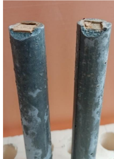
Рисунок 1. Визуальная оценка коррозионной стойкости алюминиевой пластины в среде шлакощелочного вяжущего в возрасте 1 и 28 суток
