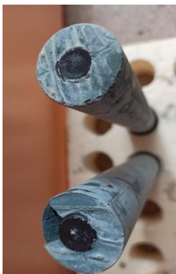
Рисунок 2. Визуальная оценка коррозионной стойкости пластиковой пластины в среде шлакощелочного вяжущего в возрасте 1 и 28 суток
