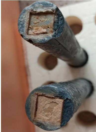
Рисунок 1. Визуальная оценка коррозионной стойкости алюминиевой пластины в среде шлакощелочного вяжущего в возрасте 1 и 28 суток
