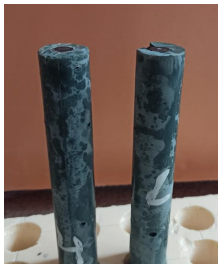
Рисунок 2. Визуальная оценка коррозионной стойкости пластиковой пластины в среде шлакощелочного вяжущего в возрасте 1 и 28 суток
